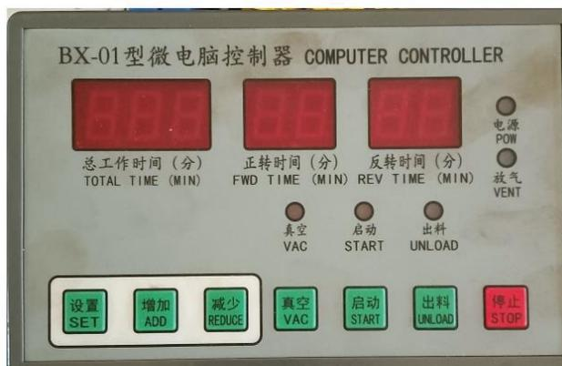
На панели управления имеются табло по общему времени работы, время работы прямой привод, время работы в обратном направлении. Установка по времени вводится в ручном режиме до начала операции.
